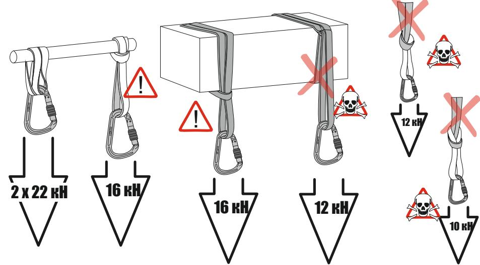
Рис. 3. Распределение нагрузок на анкерные точки в зависимости от углов
