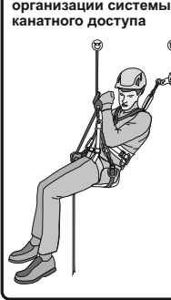
Рис. 12. Пример организации системы канатного доступа
